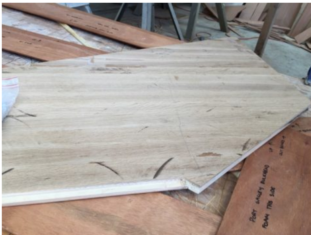
Puis les lattes, qui débordent un peu du panneau quand elles sont collées, sont retouchées.
